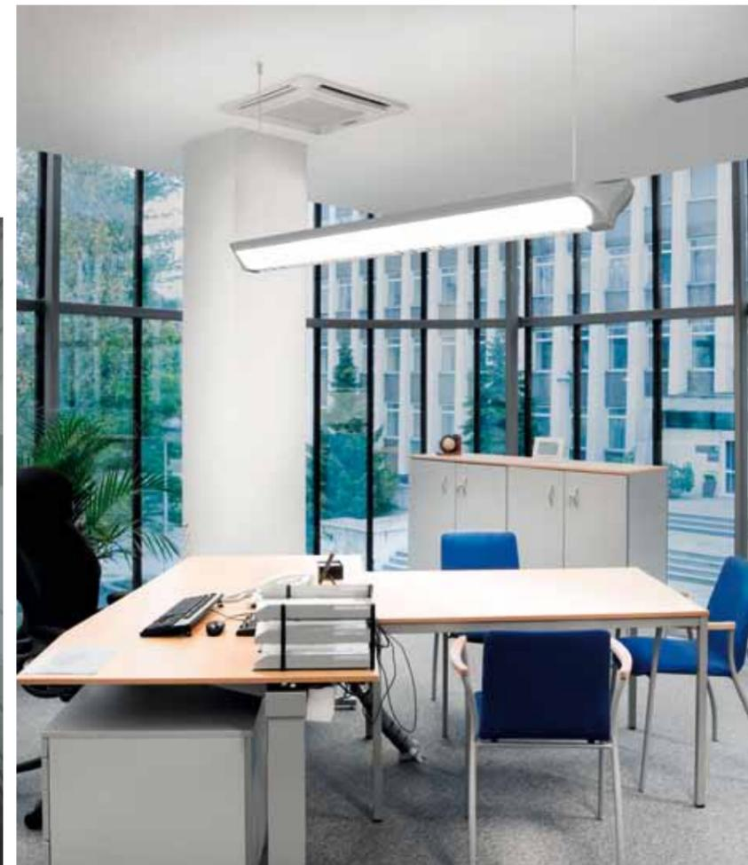
Optimale, stimulierende Bedingungen für konzentriertes Arbeiten kann die richtige Wahl der Farbtemperatur des Lichts schaffen. Für Büros empfiehlt sich Licht mit einer neutralen weißen Farbe und einer Farbtemperatur von 4000 K. Der höchste Sehkomfort für die Mitarbeiter lässt sich jedoch mit einem System zur Tageslichtsimulation erreichen.
