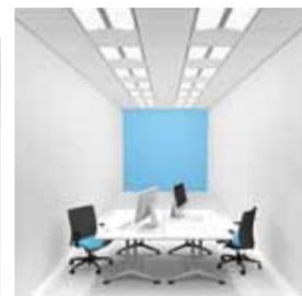
Ein ähnliches Ergebnis wie bei hängenden Leuchten mit direkter und indirekter Charakteristik der Verteilung des Lichtstroms kann mit eingelassenen Leuchten mit einem speziell geformten Diffusor erreicht werden.
