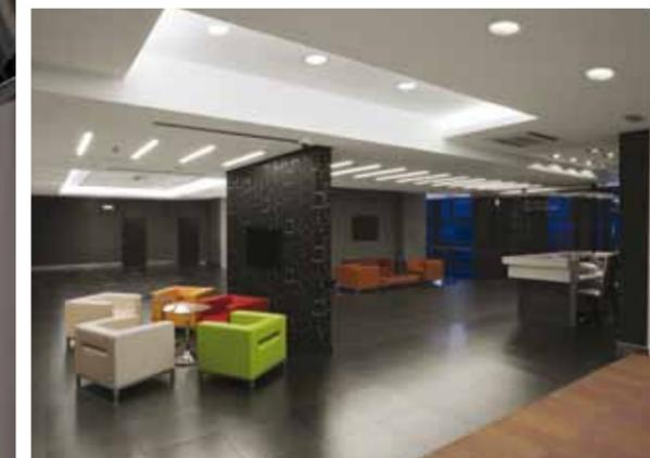
*Als Hauptbeleuchtung für den Empfangsbereich können eingelassene Leuchten mit einer direkten Lichtverteilung und einem engen Abstrahlungswinkel verwendet werden. Für die Beleuchtung des Unternehmenslogos eignen sich Akzentleuchten oder Leuchten mit einer asymmetrischen Beleuchtungskurve.*
