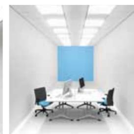
Die moderne Beleuchtungslösung umfasst die neuesten Typen von eingelassenen LED-Leuchten, die mit direkter und indirekter Verteilung des Lichtstroms und speziell geformtem Diffusor einen Teil des Lichts auch an die Decke leiten. Die Decke wird so ausreichend beleuchtet und der Raum wirkt optisch größer. Ein so beleuchteter Raum erfüllt die Anforderungen des LG7-Standards.
