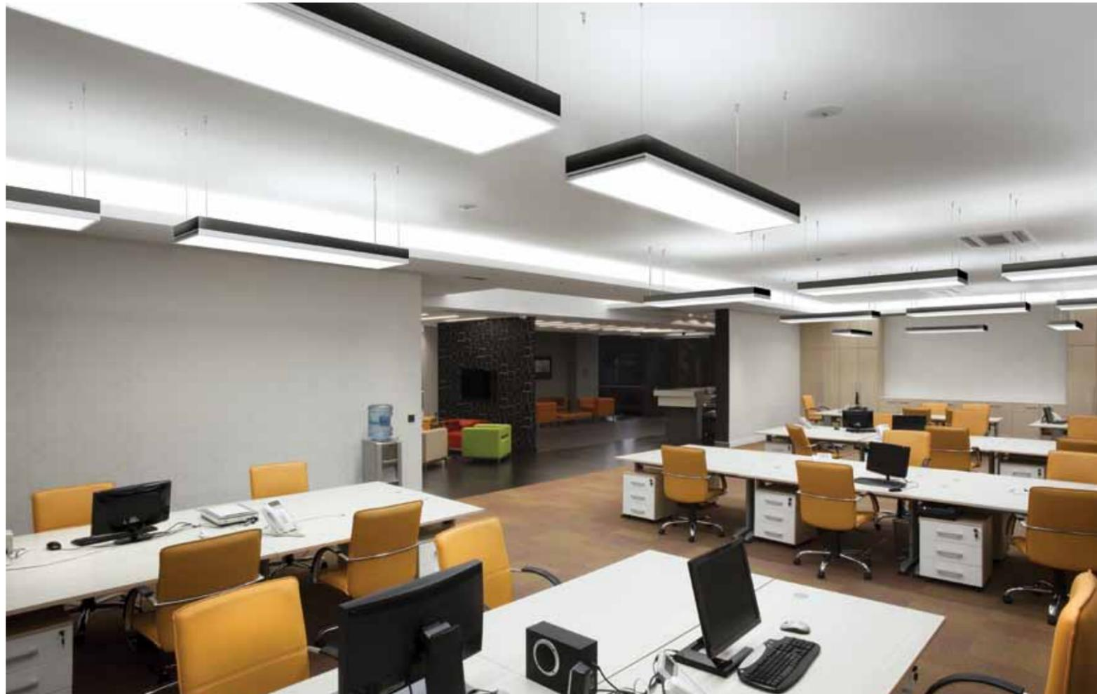
Das MODUL BOX MAX mit direkter und indirekter Charakteristik der Verteilung des Lichtstroms schafft optimale blendungsfreie Lichtbedingungen am Arbeitsplatz.
