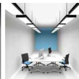
Ein geeigneter Leuchtentyp, der an die vertikale Beleuchtung der Bürowände gestellten Anforderungen entspricht, ist beispielsweise die integrierte Leuchte RELAX ASYMMETRIC LED mit deutlich asymmetrischer Strahlungscharakteristik.
