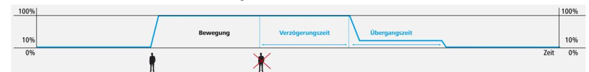
Ist es von Vorteil, die Sensoren so zu positionieren, dass sich deren zu scannenden Flächen zeitweise überdecken. Wichtig ist es, die Installation eines solchen Sensors in der Nähe von Straßenlaternen, Klima- und Heizanlagen und anderen Quellen mit intensiver Infrarotstrahlung zu vermeiden, die seine Funktion beeinträchtigen können. Bei einer korrekten Installation reagiert der Sensor unmittelbar, nachdem eine Person die gescannte Zone betreten hat.
