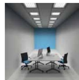
Die klassische Lösung der Bürobeleuchtung mit hinter Gitterraster eingelassenen Leuchten stellt zwar eine ausreichende Beleuchtung der Arbeitsfläche sicher, aber die oberen Teile der Wände und die Decke bleiben dunkel. Eine solche Beleuchtung verursacht einen Höhleneffekt und verkleinert den Raum optisch. Ein solches Beleuchtungssystem erfüllt die Empfehlungen des LG7-Standards nicht.
