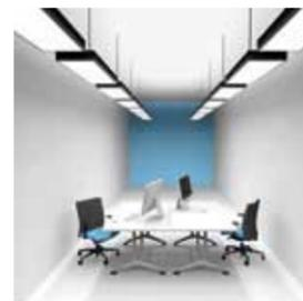
Optimale Werte einer harmonischen Verteilung der Helligkeit im Raum können durch die Verwendung von hängenden Leuchten mit direkter und indirekter Charakteristik der Verteilung des Lichtstroms erreicht werden.
